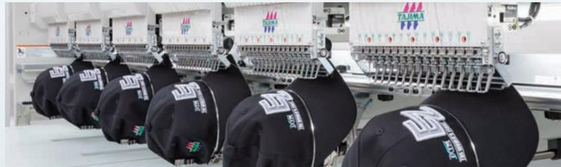
El refuerzo de la estructura de soporte del bastidor de gorras ha contribuido a la estabilización del acabado del bordado, aumentando drásticamente la velocidad máxima de rotación hasta 1.000 rpm.
